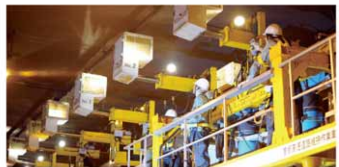
上下左右前後に動く格納バケットが、水噴霧ヘッドの位置をキャッチ
