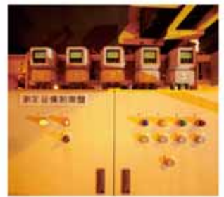
水噴霧ヘッドの個別放水量の測定が可能
